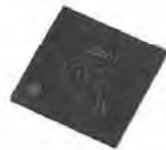
日本無線 SLAS対応チップ(JG11) 9.0×9.0mm
