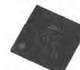
日本無線 CLAS対応チップ JG11 9.0×9.0mm
