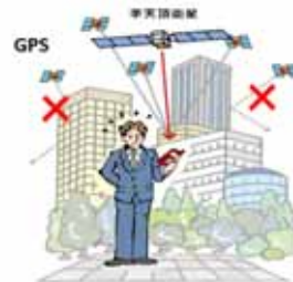
ほぼ真上(準天頂)からの信号により精度向上(衛星数増)
