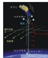
導電性テザーによる デブリ除去の原理
