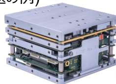
COTS品活用で従来の約100倍演算能力がある スウェーデンUnibap社の宇宙用高性能計算機
