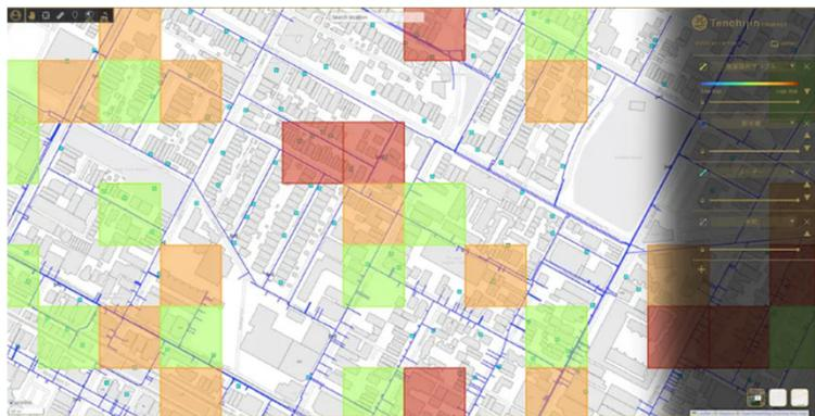
システムのサンプル画像。水道管の漏水リスクを表示
