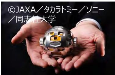
搭載された小型探査ロボット「SORA-Q」(直径約8センチ)
