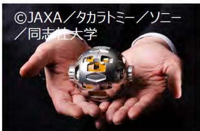
搭載された小型探査ロボット「SORA-Q」(直径約8センチ)
