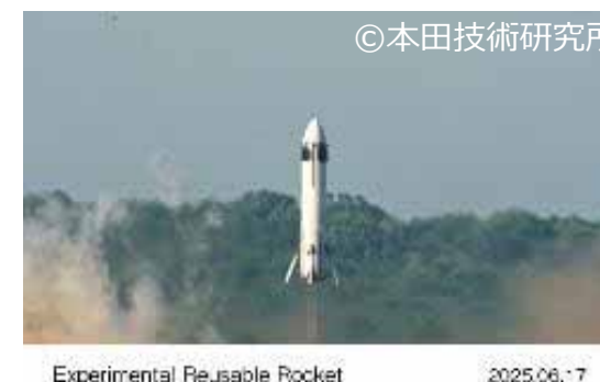
再使用型ロケットの離着陸実験（北海道大樹町） 実験機（全長6.3m, 直径85cm, 乾燥重量900kg）による高度300mまでの離着陸実験に成功。
