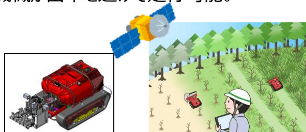
植栽・下刈り機械のイメージ (植栽と下刈り用のアタッチメントを交換する方式で開発・実証中)
