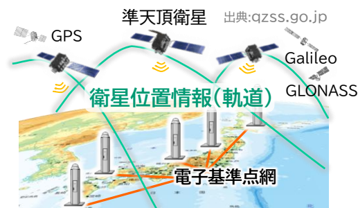
電子基準点網を利用した 衛星位置情報の生成(イメージ)
