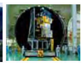
環境試験設備
