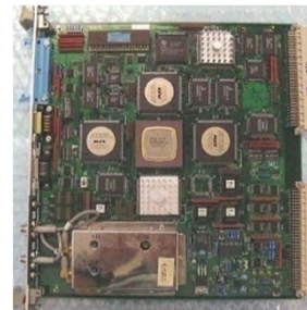
再半田を繰り返してパターンがはがれた基盤(写真は再現試験時のもの)
