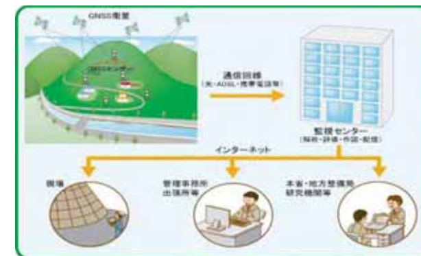
地盤や構造物の変位を計測するGNSSセンサ(第2回国土交通大臣賞、山口大学)
