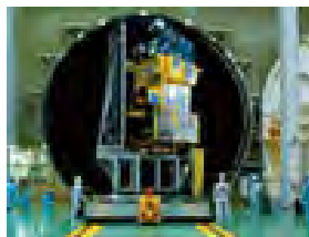
環境試験設備
