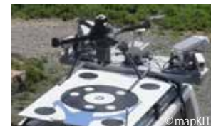
[mapKITE] 地上車両と、無人ドローンを使った航空地図作製システム。 Galileo/EGNOSの測位データを活用して自動的に地図データを作成。
