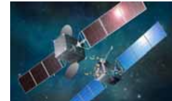
相手衛星を捕まえ、燃料補給（SSL） 同社HPより
