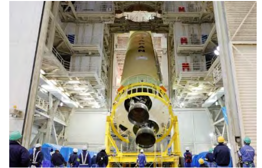
2021年2月2日(火) 1段機体の起立作業
