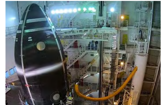
2021年6月7日(月) フェアリングアンピリカル離脱試験
