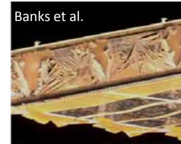
アルミニウム蒸着した単層ポリイミドフィルムが原子状酸素の影響を受けて破断(1年間の曝露後。ISSでの先行実験)
