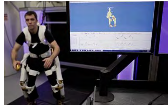
宇宙ロボットから派生した、下半身不随者の外骨格歩行支援装置
