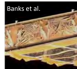
アルミニウム蒸着した単層ポリイミドフィルムが原子状酸素の影響を受けて破断(1年間の曝露後。ISSでの先行実験)
