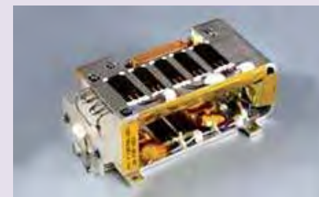
高排熱システム (平板型ヒートパイプ)
