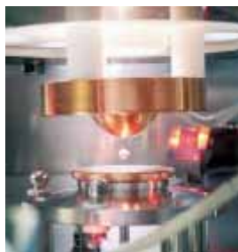
静電浮遊法による無容器実験。直径2mmの金属球を浮遊溶融。
