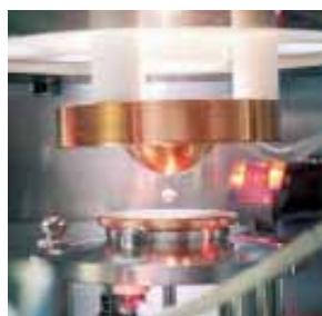
静電浮遊法による無容器実験。 直径2mmの金属球を 浮遊溶融。
