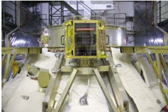
主衛星搭載アダプタへの 超小型衛星搭載
