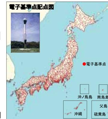
電子基準点による地殻変動の監視
