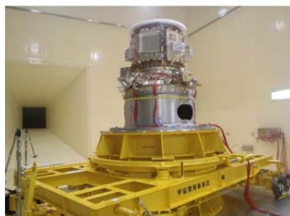
第3段階搭載機器 音響試験 (2012年5月筑波宇宙センターにて実施)
