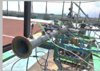
ジェット/ロケット燃焼 モード切替実験 (PDE-S)
