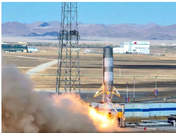
中国民間ロケットベンチャー藍箭航天空間科技 「朱雀3号(Methane/LOX推進薬)」 垂直離着陸実験(2023年9月)
