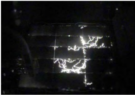
太陽電池パネル上での放電(地上試験)
