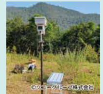
タイ北部チェンマイの森林内に設置した森林火災センサー送信機
