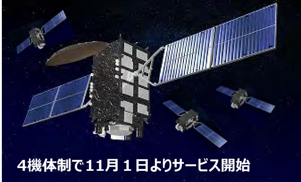
※ みちびき(準天頂衛星システム)：日本の天頂付近(準天頂)を通る軌道を持つ人工衛星3機と静止衛星1機を組み合わせて、常に1機以上の衛星を日本の上空に配置することができる日本独自の測位(位置を測定する)衛星システムです。
