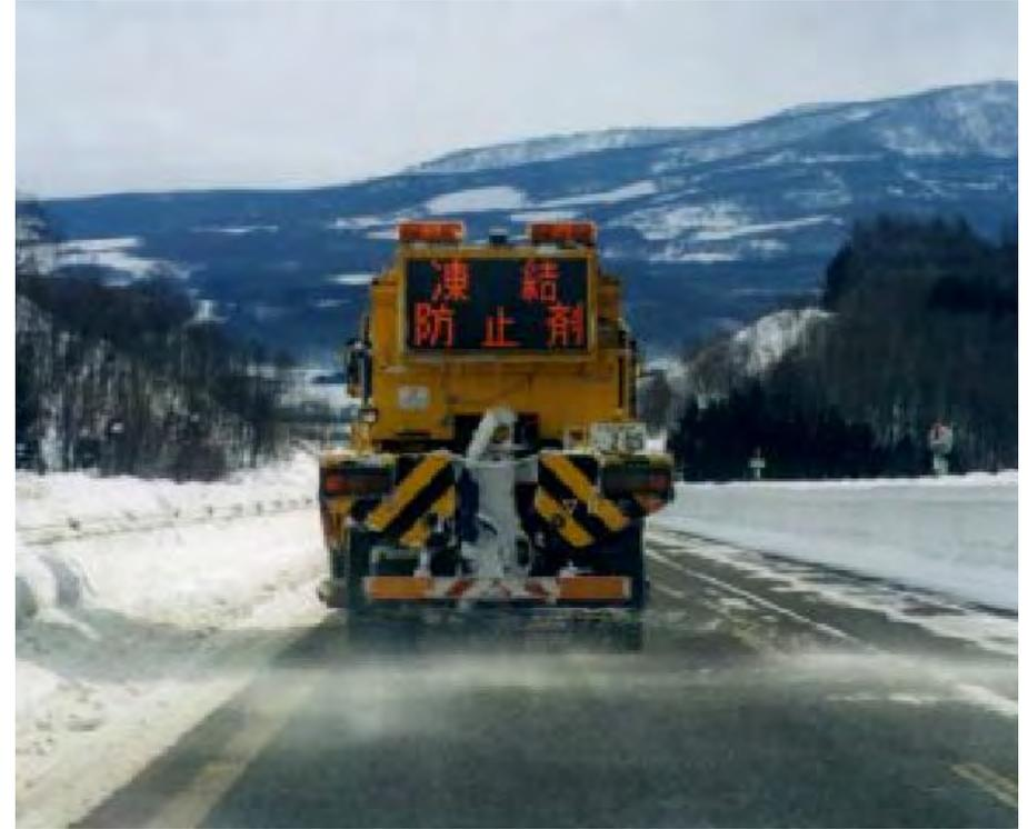
※除雪車には「GPS」を標準装備して、車両の運行・作業状況を監視し、お客様に作業状況を情報提供しています。また、除雪車が作業の要注意箇所に差し掛かると、自動でオペレータに音声ガイダンスします。
