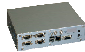
車車・路車間 通信機 (開発中)
