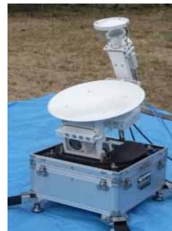
可搬型USAT(径45cm) 上:最大6Mbps 下:最大155Mbps
