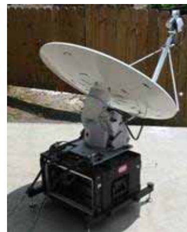
可搬型VSAT(径100cm) 上:最大51Mbps 下:最大155Mbps
