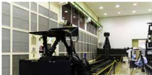
ランデブ・ドッキングシステム開発試験設備
