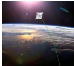
膜を展開し薄く存在する地球大気・太陽風を受けて軌道周回速度を減速、脱軌道・高度低下を促進
