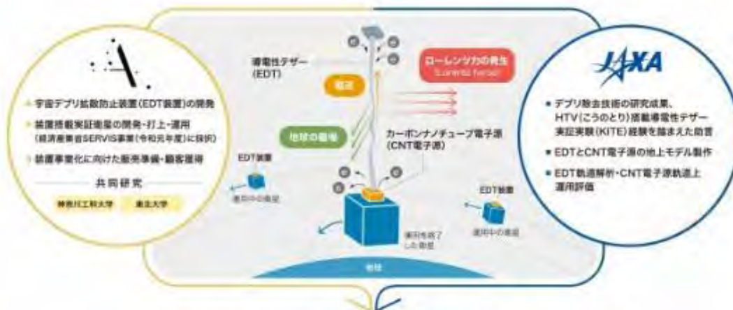
小型衛星に搭載したEDT装置から電気を通すテザー（ひも）を伸展し、軌道離脱 宇宙デブリの拡散を未然に防ぎ、サステイナブルな宇宙開発へ貢献
